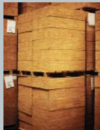
Aus den Korkblöcken werden „Sheets“ gemessert
